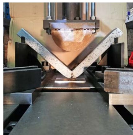
Neues Stahl-Holz-Material für Batteriewannen im Belastungstest an der TU Graz.
