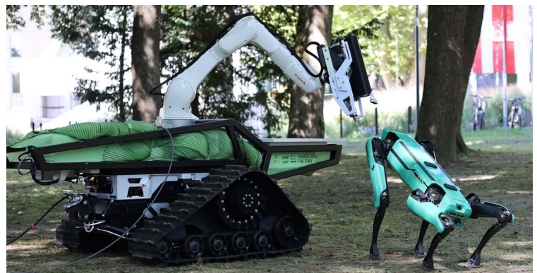
„Wandering Factory“ mobile Fertigungsplattform mit „Spot“
